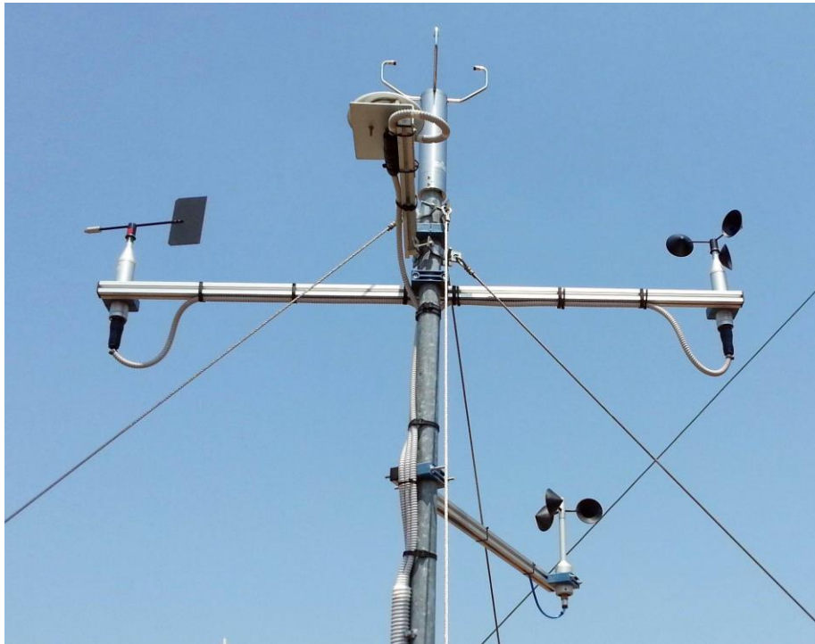
Fig. 1 - La stazione meteorologica DMG-Trieste con il piranometro Kipp & Zonen CM11 sul supporto sud.
